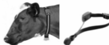
Figure 2 : accéléromètres H tag® (SCR®) et Moo Monitor® (Dairy Master/Gènes Diffusion)
